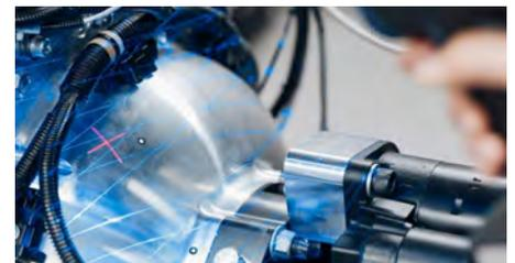
Contamos con tecnología de proyección láser y de franjas azules en escáneres 3D para capturar la superficie de sus piezas incluso con acabado brillante
