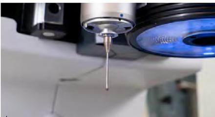
Con nuestros sensores táctiles escaneamos un gran número de puntos de medición en un único movimiento
