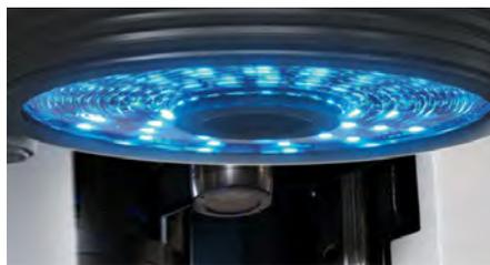
Nuestros sistemas ópticos cuentan con 3 tonos de luz para capturar sin contacto la topografía de una pieza cuando la superficie es delicada, reflectante o de bajo contraste
